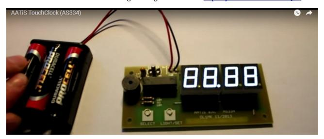
**Ergänzung zum Artikel im Praxisheft 24:** Je nach gewünschter Helligkeit kann die TouchClock mit zwei unterschiedlichen Versorungsspannungen betrieben werden (3 oder 4,5 V). Beim Einsetzen der Batterien ermittelt die Firmware automatisch, welche Betriebsspannung vorliegt. Deshalb darf innerhalb der ersten Sekunden **bis zum Aufleuchten der Anzeige kein Sensor berührt werden.**
